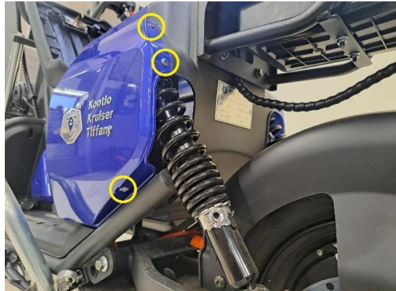
Irrota istuimen vasemmanpuoleisen alasivumuovin kiinnitysruuvit (ristipäämeisseli ph2).
